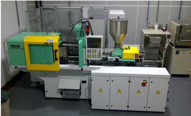
Obr. 2 Vstřikovací stroj ARBURG 270 S 400-100 a vstřikovací forma typ D2 Bild 1 Spritzgießmaschine ARBURG 270 S 400-100 a Spritzgießwerkzeug typ D2
