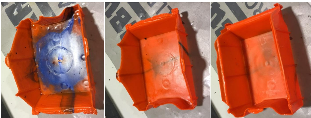
Obr. 5 Čištění komory vstřikovací jednotky a horkého vtoku od předchozího materiálu
