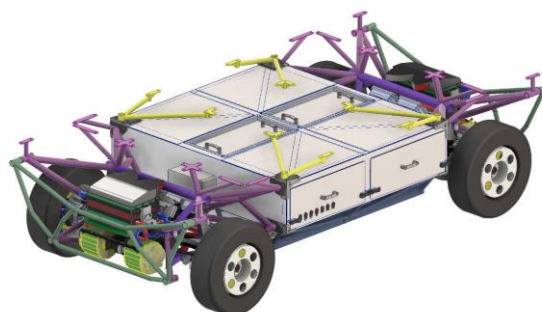
Konstrukce rámu autonomního vozidla (J. Svatý, 2022)
