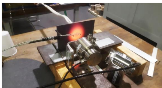
Lokální opravy smaltovaných povrchů pomocí indukčních ohřevů (K. Ungr, 2020)
