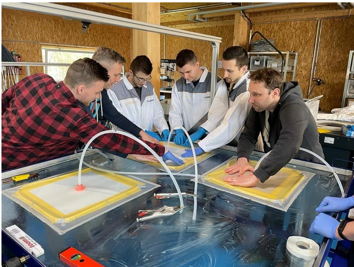
Infuzní laminace kompozitů studenty FS TUL ve spolupráci s Fraunhofer-IWU (Žitava, Německo)
