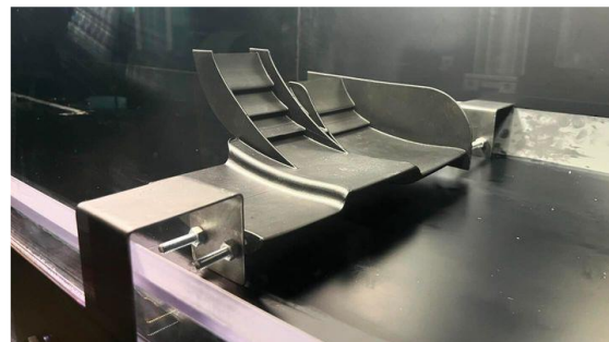
Studium úplavu za aerodynamickým profilem (P. Uhlíř, 2024)
