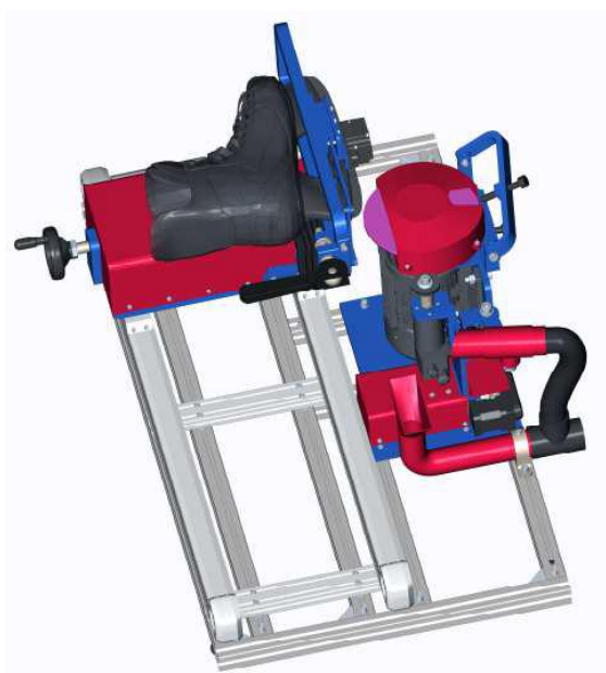
Poloautomatické zařízení na broušení bruslí (J. Matějka, 2024)
