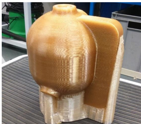
Analýza využití 3D tisku pro výrobu tlakových nádob (F. Veselka, 2017)
