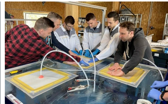
Infuzní laminace kompozitů studenti FS TUL ve spolupráci s Fraunhofer-IWU (Žitava, Německo)
