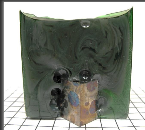
Korozní test ve sklovině
