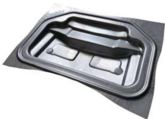
Tažení výlisku z korozi-vzdorného materiálu při použití nástroje s proměnnou přidržovací silou (M. Herman, 2015)
