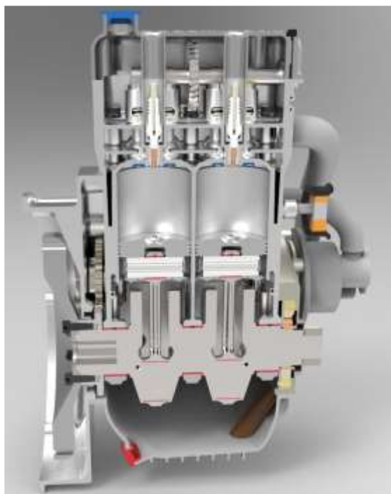
Projekční návrh spalovacího motoru pro hybridní vozidlo (R. Rybáček, 2017)
