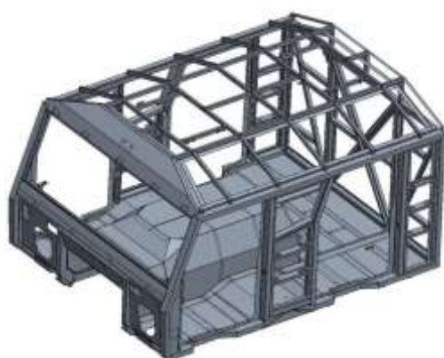
Konstrukce kabiny nákladního automobilu (O. Kamenskiy, 2022)
