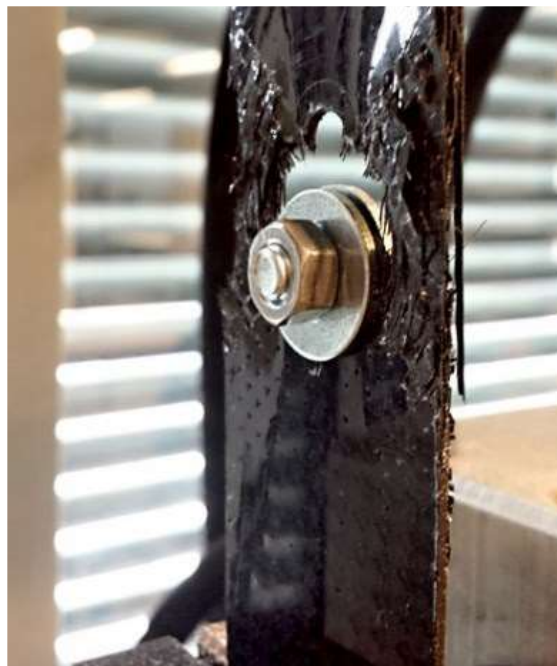
Šroubový spoj kompozitního systému na bázi uhlíková výztuž – polymerní matrice (T. Urban, 2016)
