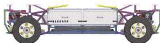
Konstrukce rámu autonomního vozidla (J. Svatý, 2022)
