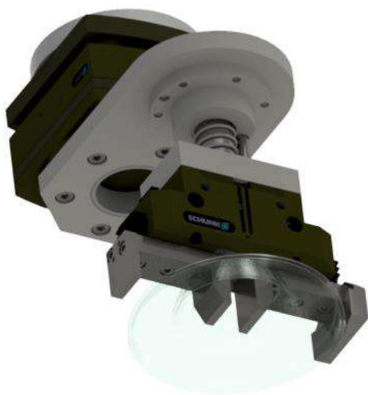
Robotické odnímání náhodně orientovaných objektů (P. Voleník, 2017)
