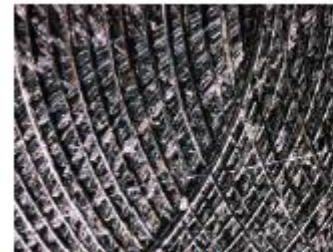
Bearbeitete Metalloberfläche mit seitlicher Beleuchtung
