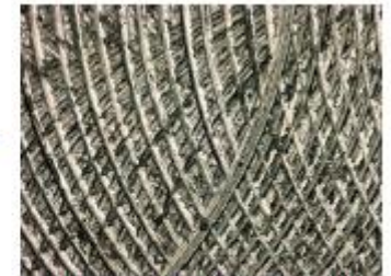
Bearbeitete Metalloberfläche mit koaxial-vertikaler Beleuchtung
